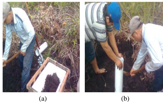
Gambar 1. Proses pengambilan sampel tanah gambut a. Sampel terganggu, b. Sampel tidak terganggu
